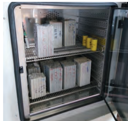
Câmara climática com prismas para carbonatação acelerada (norma suíça SIA 262/1-X)
